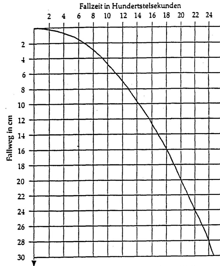
Abb. 1: Zuordnung zwischen Fallstrecke und Fallzeit
